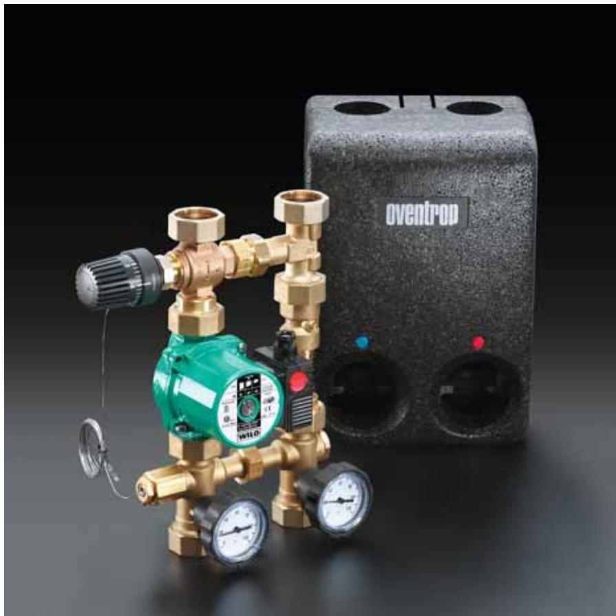
Stanica “Regumat RTA” omogućava povezivanje grejnog sistema/spremnika tople vode sa kotлом na čvrsto gorivo. Minimalna površna temperatura ka kotlu na čvrsto gorivo iznosi 55°C i nalazi se iznad tačke rose.
