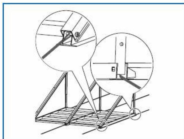
109/3 Nosači kolektora za montažu na ravan krov, sa tacnama za balast i dodatnim osiguranjem pomoću sajli
