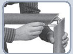
Tubolit se može lako postaviti na sve cevi i kolena pre zavarivanja, jednostavnim navlačenjem na cev ili se može montirati na već postavljen cevovod rasecanjem duž fabrički izvedenog šava, obmotavanjem oko cevi i lepljenjem Armaflex 520 lepkom ili se, umesto lepljenja, može pričvrstiti klipsnama. Montaža Tubolit izolacije je jednostavna, sigurna i čista! Preporučuje se
